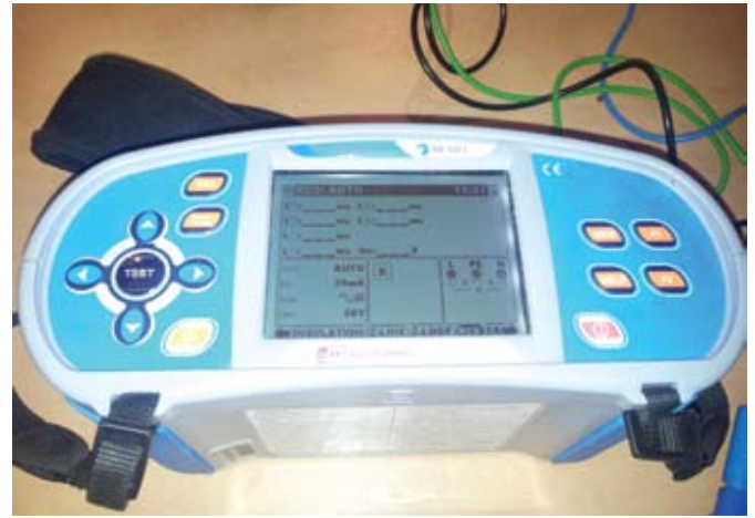
מכשיר בדיקה חשמלי. המכשיר בודק פרמטרים שונים של המפסק כמו, לדוגמה: זמן תגובה, רגישות וחלקי זרם
